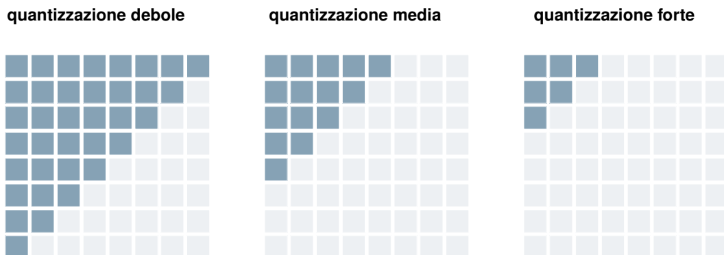
Figura 3.26. Illustrazione concettuale dell'effetto della quantizzazione nel dominio DCT: aumentando il passo, una regione crescente di coefficienti tende a diventare zero. Non è il risultato di una fotografia specifica.
